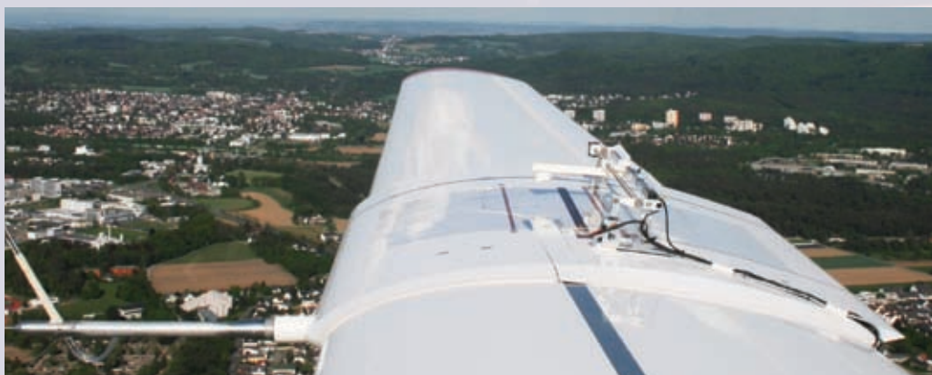
Эксперимент Дармштадтского технического университета по размещению плазменного актуатора на крыле самолета
