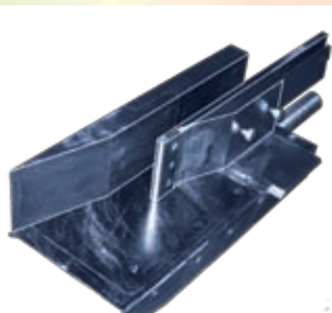
Модель для исследования течения в гиперзвуковом воздухозаборнике
