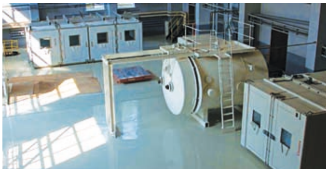
Теплопрочностные камеры климатической лаборатории комплекса прочности
