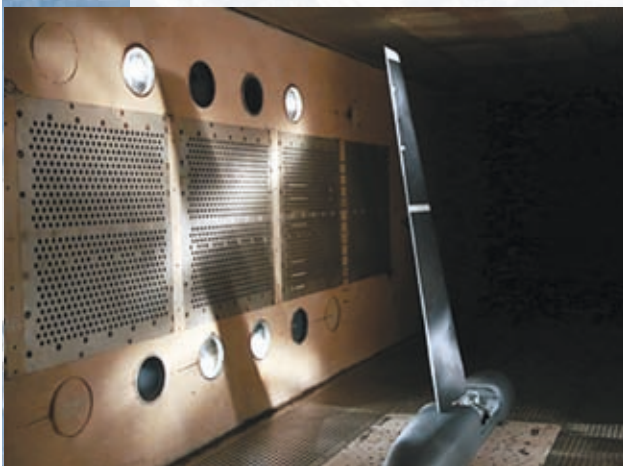
В ЦАГИ испытывают аэроупругую multifunctional модель крыла
