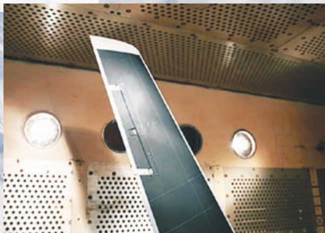
В ЦАГИ испытывают аэроупругую multifunctional модель крыла
